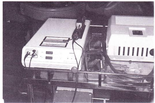
図5 炭酸ガスレーザー (Laser SAT CO<sub>2</sub>, 最大出力 5 W). 装置が非常にコンパクトで軽量である.
