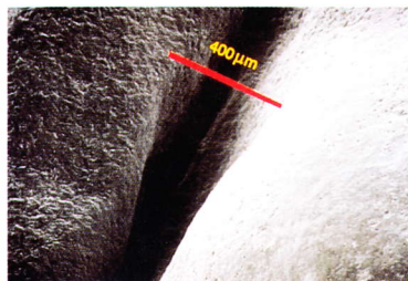
図10 最小サイズ015 (375 \mu m) のノズルで2回(2秒間)往復させ切削させた SEM 像。幅の広い場所でも400 \mu m でノズル口より25 \mu m 増加しているのみである。
