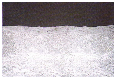
図14 噴射切削による窩洞の断面 SEM 像。表面は平滑でマイクロクラックやチップは認められない。
