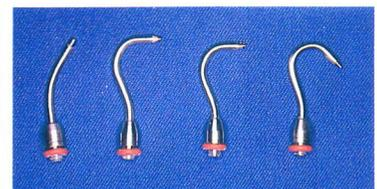
図5 ノズルの噴出口径は小、中、大。彎曲度は3種類
