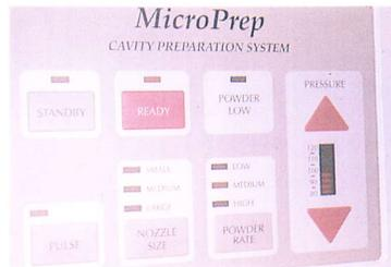
図2 本機は気圧、ノズルのサイズ、粒子の噴出率、パルスモードが調節可能
