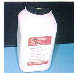
図3 Micro Prepに使用される酸化アルミナ粒子(50 $\mu$ m)
